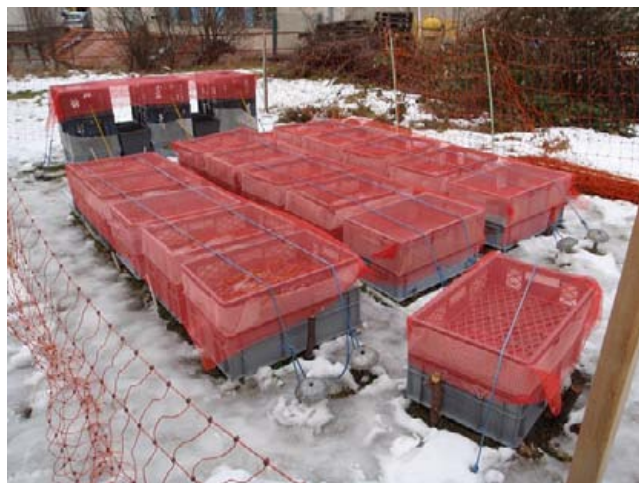
Versuchsanlage zum Biomasseverlust von Winterbegrünung im Hof der MA 39 © Bio Forschung Austria
