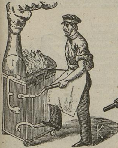
K. k. leichttransportable doppeltwirkende Cylinder-Feldschmiede.
