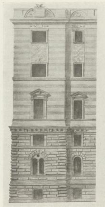
Wettbewerbsentwurf für den Stockwerksaufbau des Justizpalastes in Wien, 1929 Ein Vorschlag, das schwere Hauptgesimse abzutragen und das oberste Geschoß mit dem neu aufzubauenden zusammenzufassen
