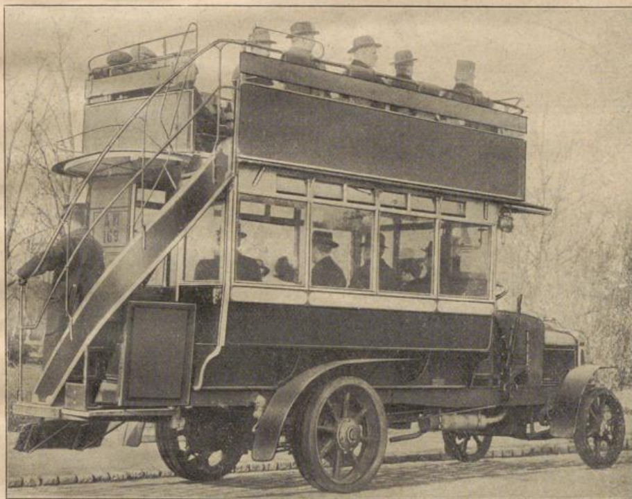
Abb. 243. Kraft-Stellwagen mit offenem Oberdeck in London, Untergeschoß mit 2 Längsbänken, oben Querbänke. (Chassis-Typ der Engl. Daimler-Werke Coventry mit Knight-Schieber-Motor, Kettengetriebe und Wurmantrieb)
