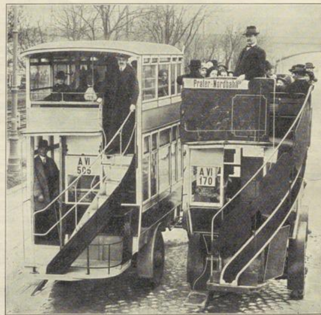
Fig. 4. Wiener Kraftstellwagen, Patent Spängler (links) und Londoner Autobus (rechts).
