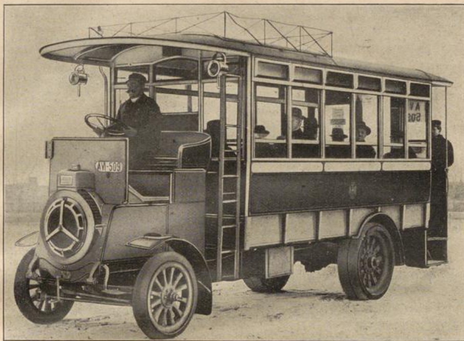
Abb. 246. Eingeschossiger Kraft-Stellwagen, Pariser Typ. (Querbänke und Stehplätze; Chassis von De Dion-Bouton; Wurmtrieb mit gelenkiger Quer-Verbindung auf beide Hinterräder wirkend)
