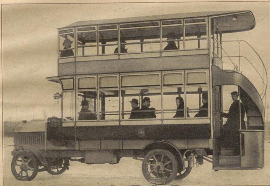
Abb. 253. Neuer Kraft-Stellwagen in Wien, Patent Spängler. (Geschlossenes Obergeschoß, Sicherheits-Stiege, Chassis der Österreichischen Vereinigung von Daimler, Fiat, Gräf u. Stift, Ventilmotor, engl. Kettengertriebe und Wurmrad-Antrieb).
