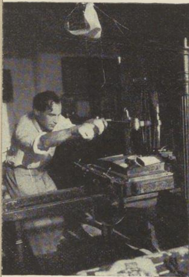
Abb. 13. Druckstellung bei einmänniger Bedienung.
