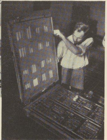
Abb. 12. Niederklappen des Rahmens nach dem Einfärben. Anblick des Rähmchens mit den ausgeschnittenen Stellen.
