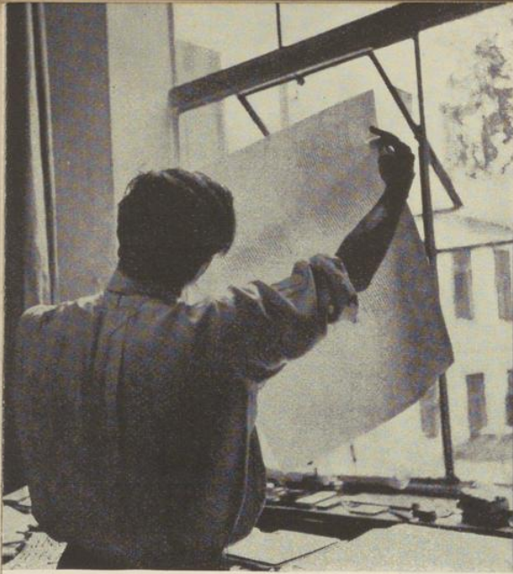
Abb. 12. Niederklappen des Rahmens nach dem Einfärben. Anblick des Rähmchens mit den ausgeschnittenen Stellen.
