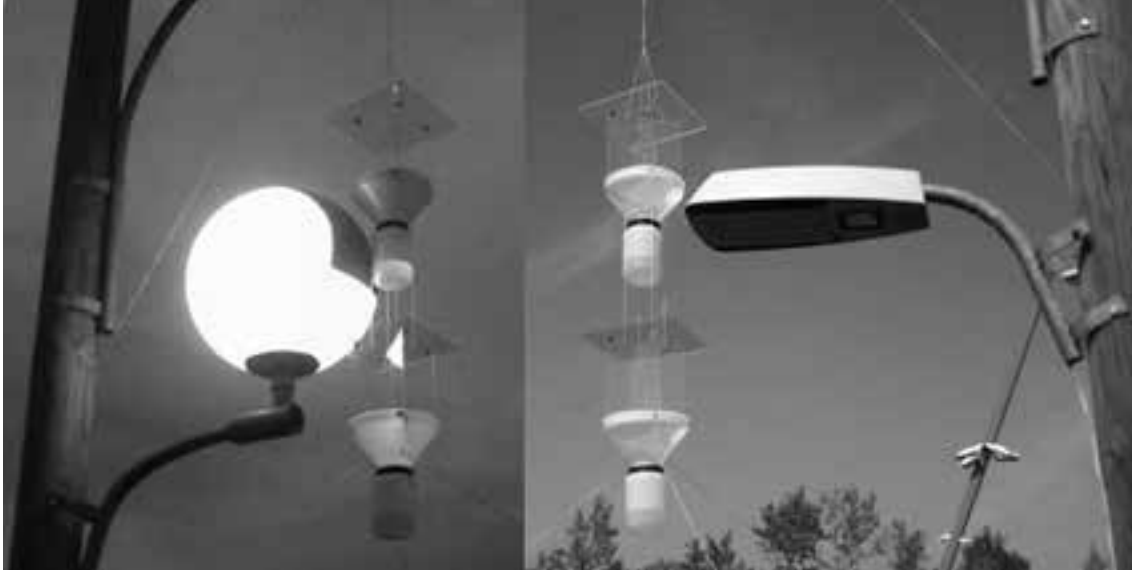
Verschiedene Versuchsaufbauten auf der Wiener Donauinsel mit deren Hilfe die Anlockwirkung auf nachtaktive Insekten untersucht wurde.
