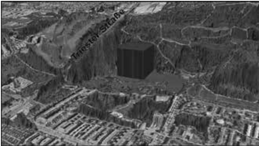
Abb. 2: Die 177 Millionen „Drasche“-Ziegel, aus denen das Arsenal gebaut wurde, ergäben 0,5 Millionen Kubikmeter Ziegelton, der in seiner Abbaugrube, der ehemaligen Ziegeltongrube östlich der Triester Straße, einen Würfel wie abgebildet einnimmt (Überhöhung berücksichtigt).
