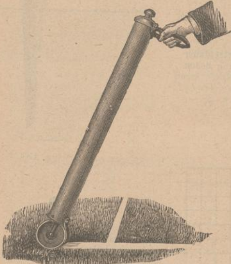
81. Spielplatz-Markierer fl. 8.80. Durch einen Druck am Handgriff öffnet sich das Ventil und läuft die Kalkmasse gleichmässig auf das Rad, so dass man ohne Mühe die Linien scharf markieren kann.
