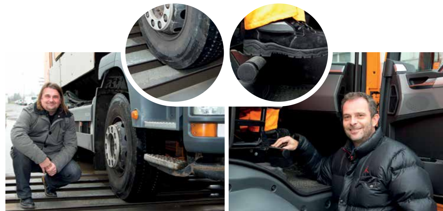
Durch den Verbesserungsvorschlag von Andreas Cap werden bei der Reifenwaschanlage (Rumpelstrecke) auf der Deponie Rautenweg Stahlprofile anstelle von Holzprofilen verwendet.
