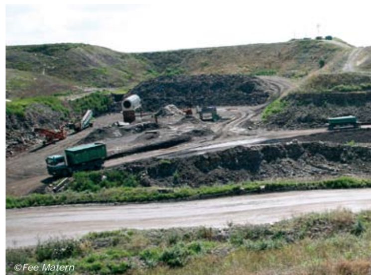
Aus „alter“ Schlacke werden Metalle rückgewonnen
