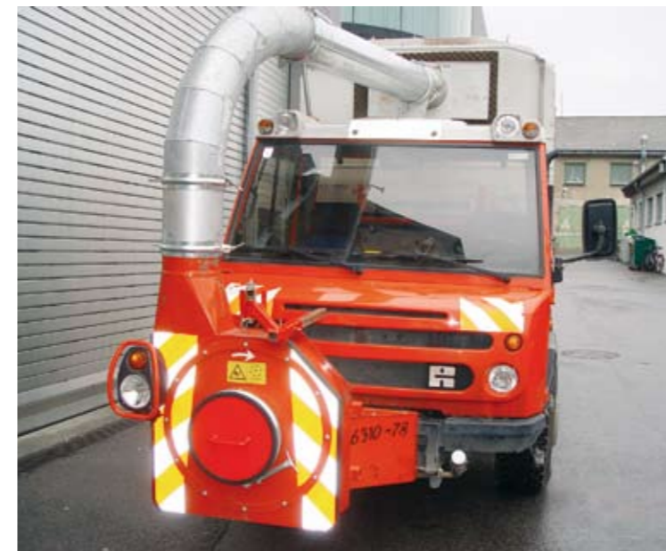
Reform Muli mit adaptierten Laubsaugeraufbau
