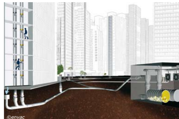
Schematische Darstellung einer pneumatischen Abfallsammelanlage
