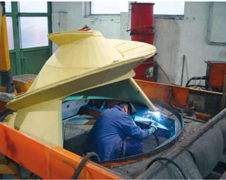
Schweißerarbeiten an einer Verdichtereinheit
