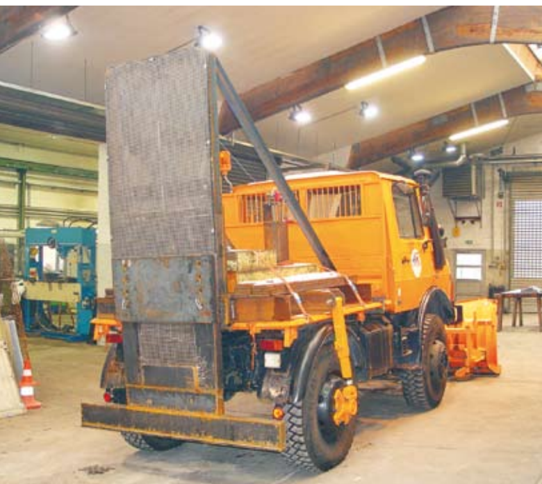
Das Lastplattengewicht, transportbereit auf einem Unimog
