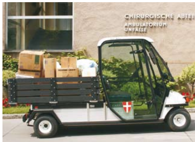
Elektro-Fahrzeuge für punktuelle Sauberkeit und Lärmarmut, z.B.: Lastentransport im Bereich des Krankenanstaltenverbundes
