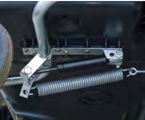
Gasdruckdämpfer ermöglichen das geräuschlose Schließen des Behälterdeckels
