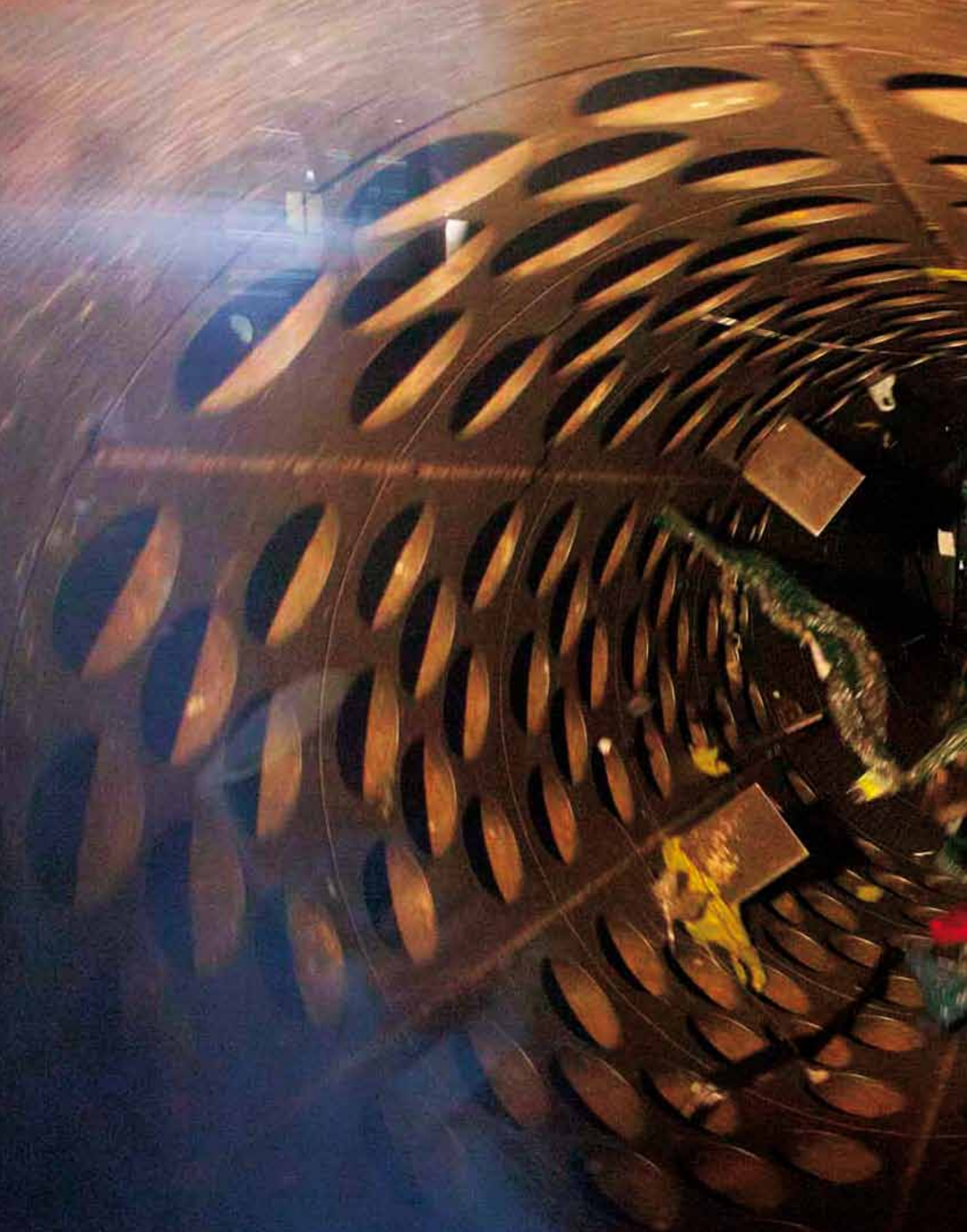
Siebtrommel der Kunststoffsortieranlage im Rinterzelt
