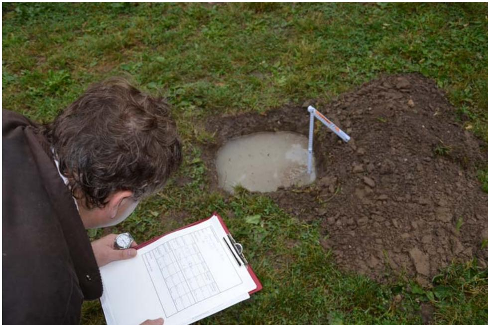
Abb 7 Einfacher Versickerungsversuch am 22.06.2015
