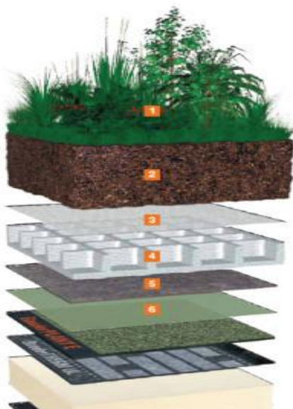
ABB.2 BEISPIELAUFBAU EINES INTENSIV BEGRÜNTEN FLACHDACHES
