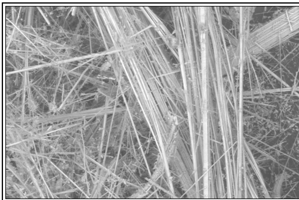
Bild 3: Amphibolasbest bei 1000-facher Vergrößerung, REM-Aufnahme (Quelle: aetas Ziviltechniker GmbH)
