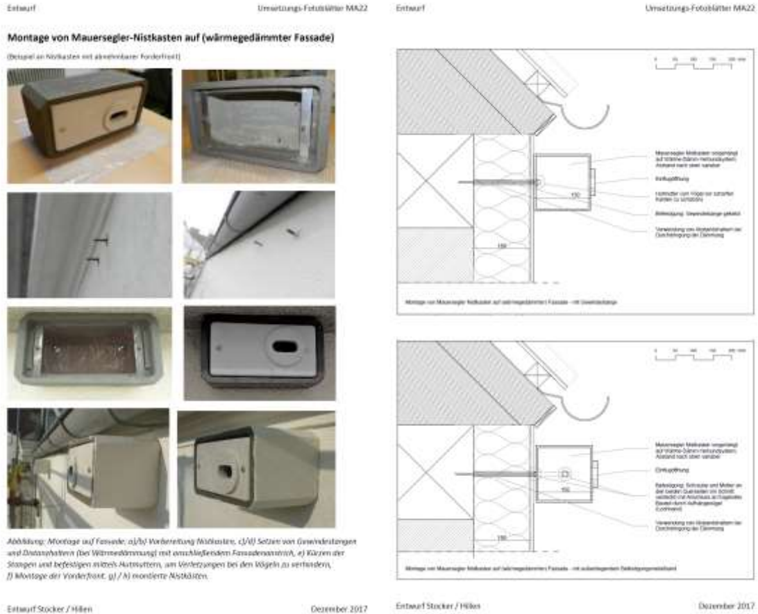
Abbildung 12: Detail 8: Montage von Mauerseglern-Nistkasten auf wärmegeämmter Fassade
