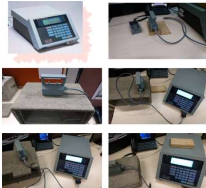
Abbildung 24: Messtechnische Bestimmung der Wärmeleitfähigkeit der Nistkästen mit QTM 500
