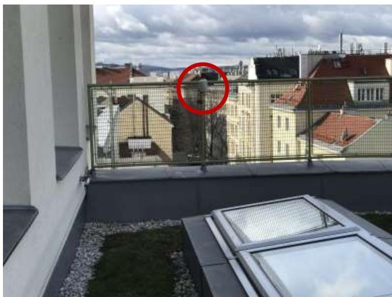
Abbildung 36: Messstation zur Erhebung der Lufttemperatur und relativen Luftfeuchtigkeit im Außenbereich mit Strahlenschutzschirm auf der Terrasse der anderen Gebäudeseite
