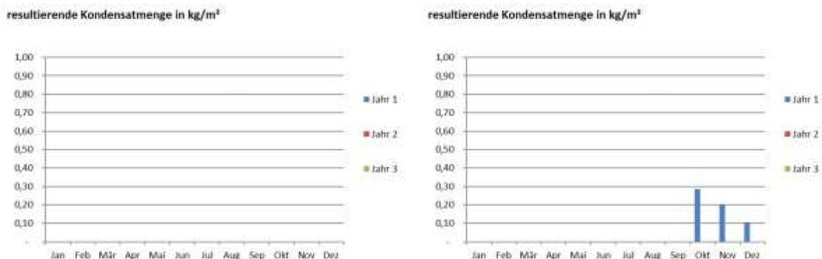
Abbildung 12: Variante a – Nachweis der Kondensatmenge; links: ohne Feuchteeintrag; rechts: Feuchteeintrag als Anfangsfeuchte von  $1\text{kg/m}^2$  in der Außenschicht (Sto-Resol)
