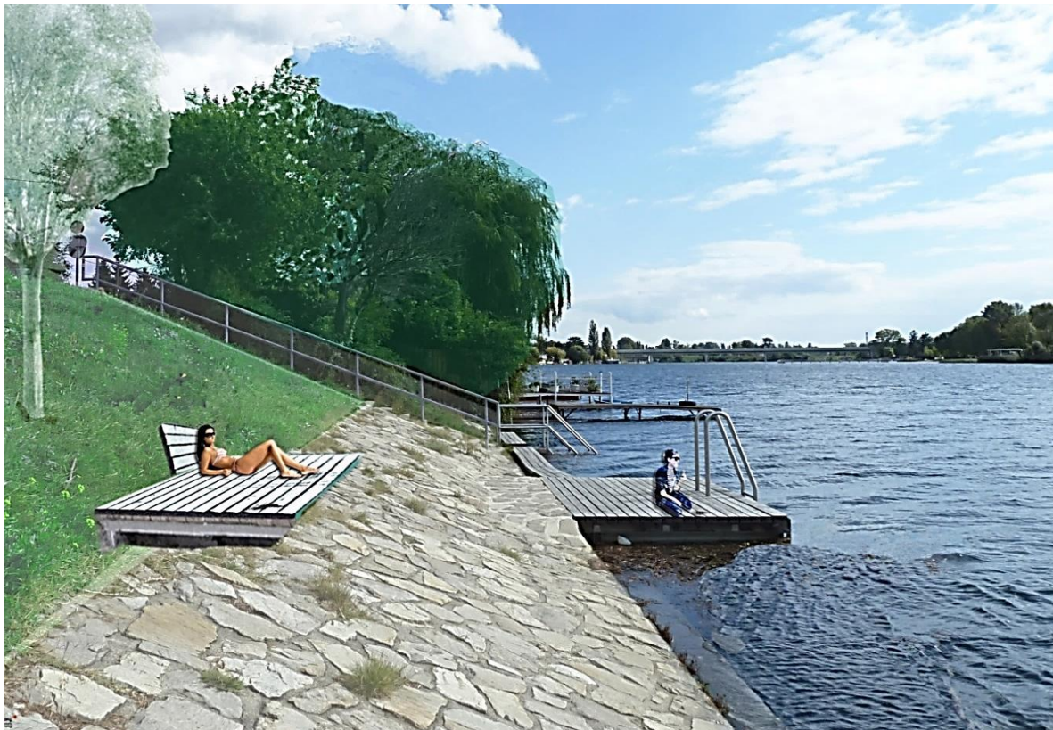
Abbildung 7.1: Holzplattform auf Stahlrahmen an gepflasterter Böschung, Plattformhöhe bis 70 cm
