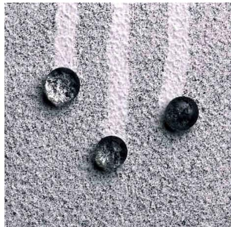
Selbstreinigende Fassade mit „Lotus-Effekt®“
