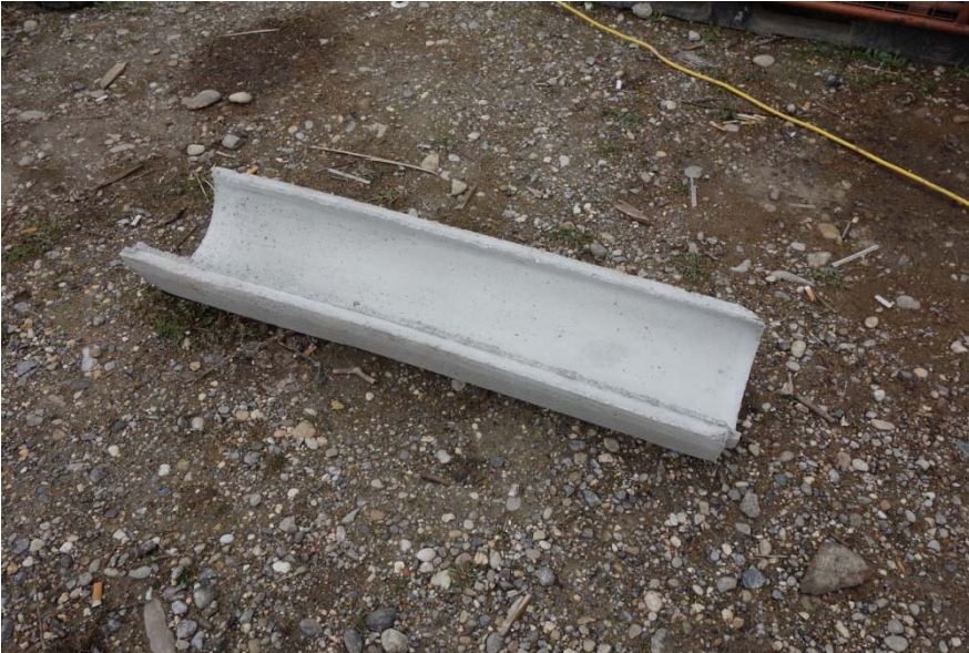
Foto 15 Musterstück Betonhalbschale zur offenen Ableitung der Regenwässer
