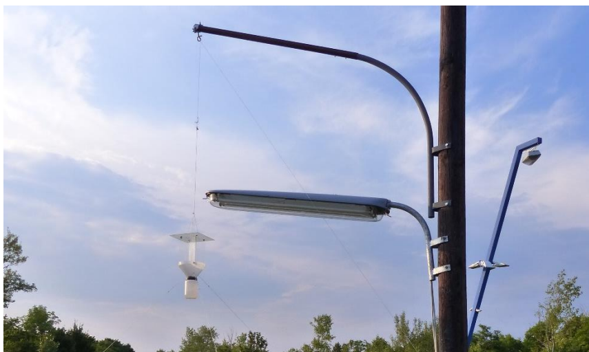
Abbildung 3: Aufbau mit Langfeldleuchte und Lichtfalle (© Martin Soneira, 2014).
