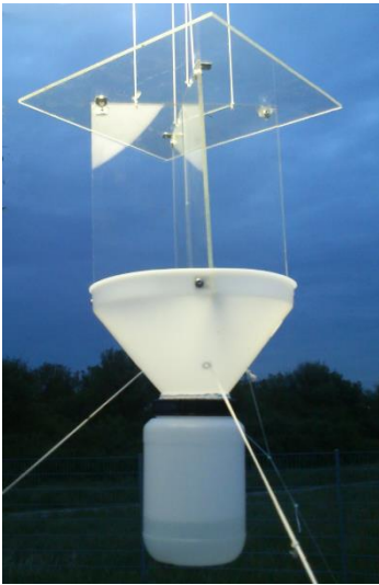
Abbildung 4: Lichtfalle bestehend aus Plexiglas, Trichterstück und Auffangbehälter.
