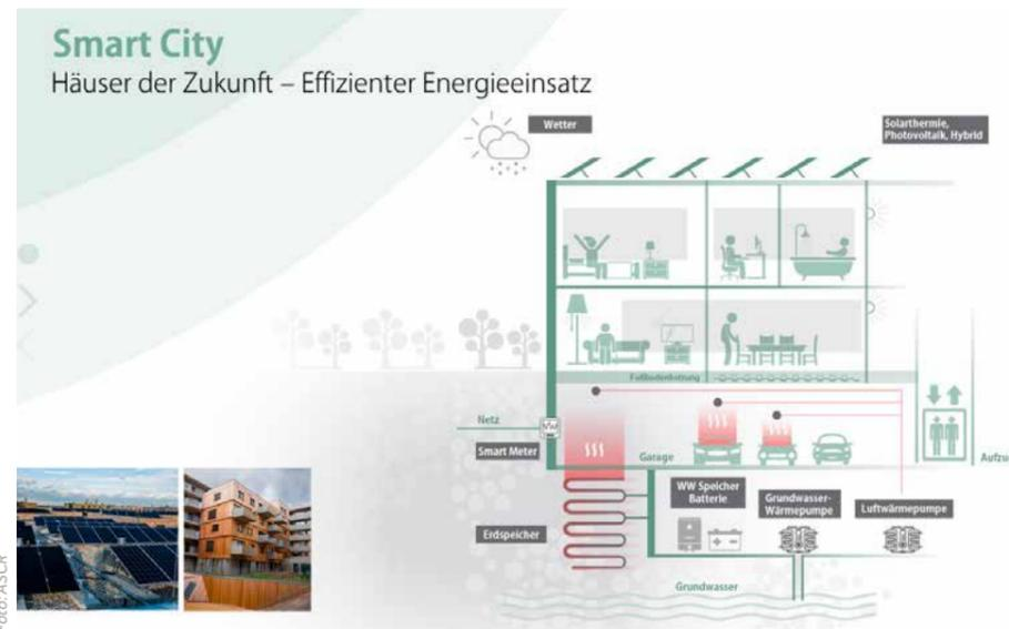
Das Energiekonzept für das als Beton/Holzriegelkonstruktion errichtete Wohngebäude setzt sich aus mehreren umschaltbaren Wärmepumpen mit verschiedenen Primärenergiequellen zusammen. Jede Wärmepumpe versorgt ausgehend von ihrer Bauart eine Nieder- oder Hochtemperaturschiene.
