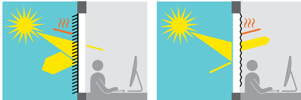
Abb. 3 Funktionsweise von außen und innen liegendem Sonnenschutz. Außen liegender Sonnenschutz verringert den Anteil der Wärmestrahlung, der durch die Fenster in den Raum dringt, durch Absorption und Reflexion. Innen liegender Blendschutz kann diese Funktion nur durch Reflexion ausüben. Die absorbierte Wärme verbleibt im Raum. Um die gegensätzlichen Ansprüche von Sommer und Winter auszugleichen, ist die Kombination beider Systeme zu empfehlen.
