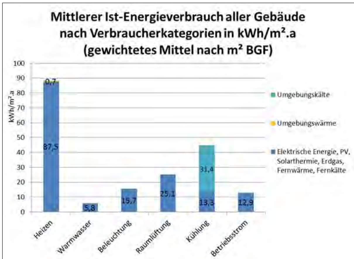
Abbildung 5: Mittlerer Ist-Energieverbrauch aller Gebäude nach Verbraucherkategorien in kWh/m 2 ·a (gewichtetes Mittel nach m 2 BGF, heizgradtagebereinigt)
