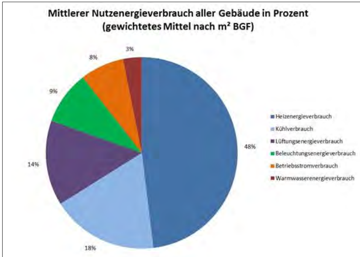
Abbildung 4: Mittlerer Ist-Nutzenergieverbrauch aller Gebäude in Prozent (gewichtetes Mittel nach m 2 BGF, heizgradtagebereinigt)
