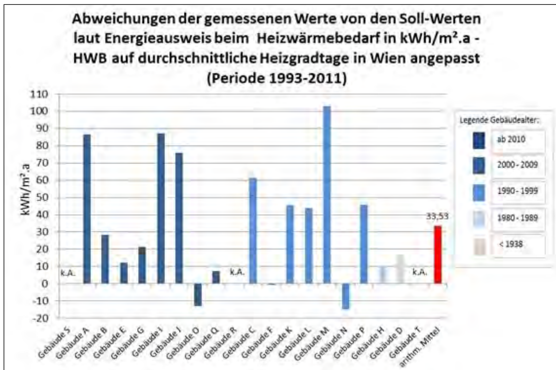
Abbildung 15: Abweichungen HWV zu den Sollwerten in kWh/m 2 .a
