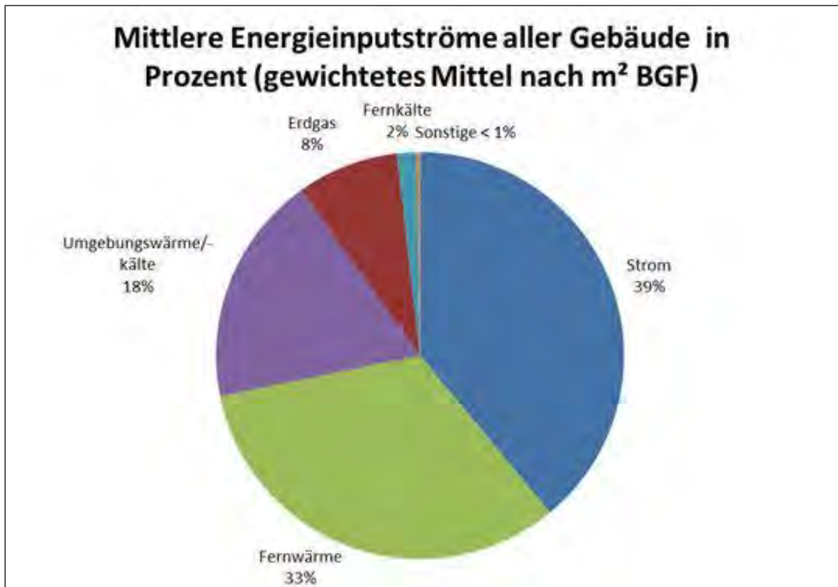
Abbildung 1: Mittlere Energieinputströme aller untersuchten Gebäude in Prozent (gewichtetes Mittel nach m 2 BGF)
