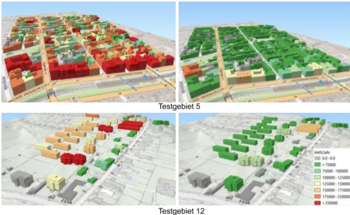
Abbildung 19: Theoretischer Wärmeenergiebedarf vor (links) und nach (rechts) Sanierung nach OIB-RL
