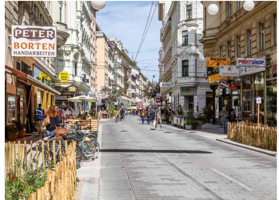
Der helle Granit reflektiert die Sonne, und das Regenwasser kann im entsiegelten Boden der neugestalteten Neubaugasse zwischen den Pflastersteinen versickern.
