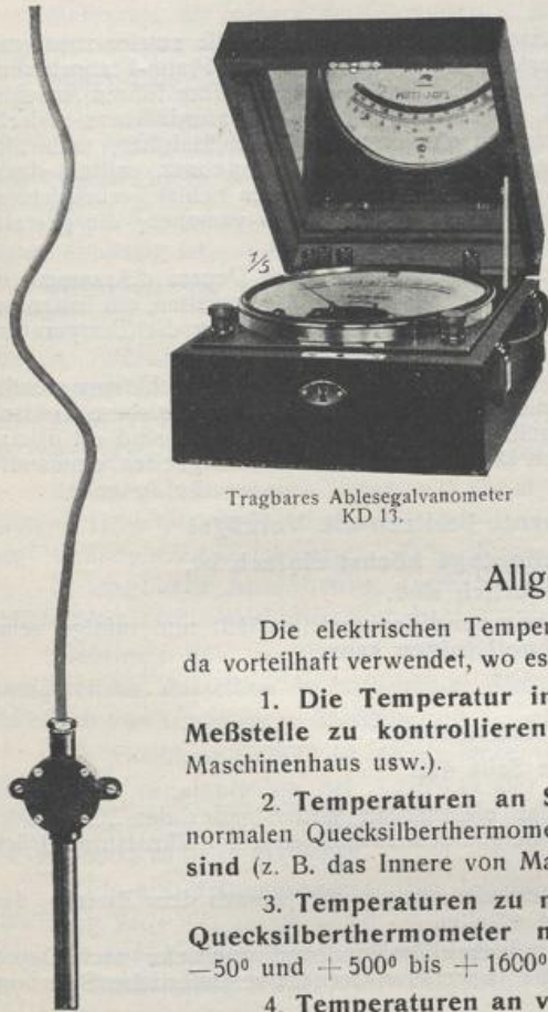
Widerstands- thermometer in spritzwasserdichter Ausführung.
