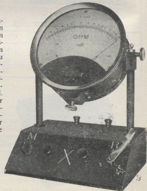
Präzisions-Ohmmeter als Standinstrument.
