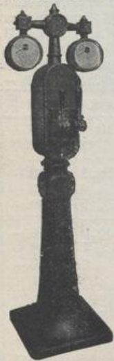
Schaltsäule mit zwei Handgriffen.
