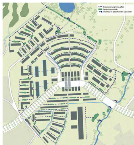
Abb. 64 Entwässerungssystem (Atelier Dreiseitl)
