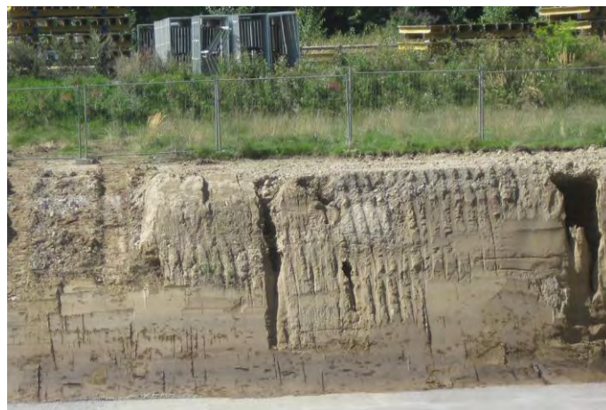
Abb. 38 Bodenaufschluss nahe BPL 2, der mächtige, kaum durchlässige Schluff-Untergrund ist erkennbar (Foto: Büro Grimm)
