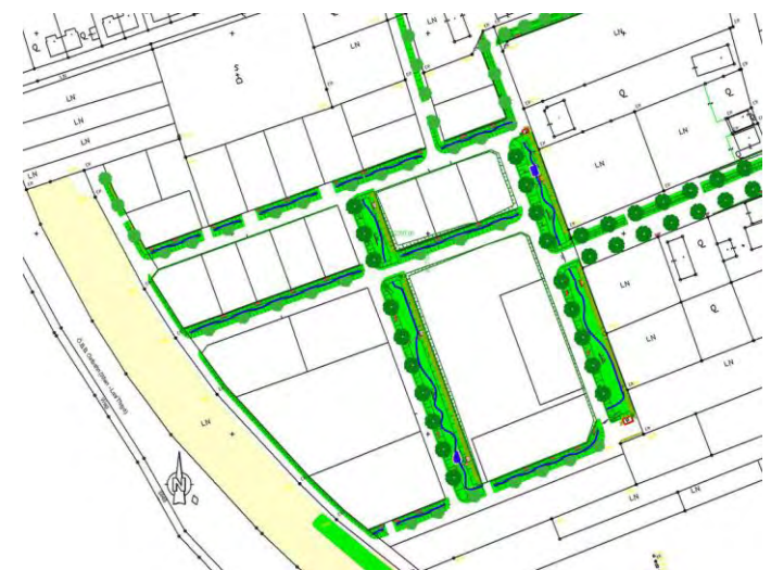
Abb. 61 Das anfallende Regenwasser wird über Ableitungsmulden in Retentionsmulden geleitet und von dort gedrosselt in den Kanal eingeleitet (Büro Grimm)
