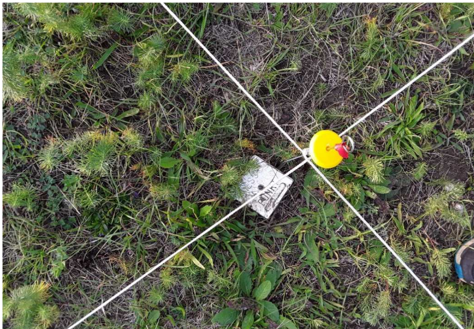
Abb. 19: Im Zentrum der Monitoringfläche ein Messpunkt mit aufgespannten Schnüren zu den Haupthimmelsrichtungen
