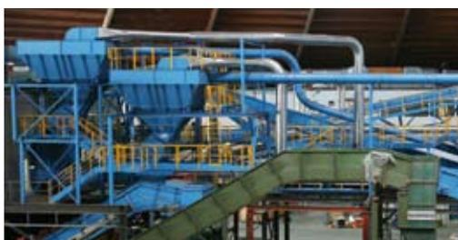
In dieser automatischen Sortierstation wird durch den Einsatz von mehrstufigen Sortieraggregaten der jüngsten Generation das von Störstoffen und Fehlwürfen weitgehend befreite Sammelgemisch nach Material und Farbe getrennt. Dabei wird ein wesentlicher Beitrag zur Ressourcenschonung von Rohmaterial für die Herstellung neuer PET-Flaschen („Bottle to Bottle“-System) geleistet.
