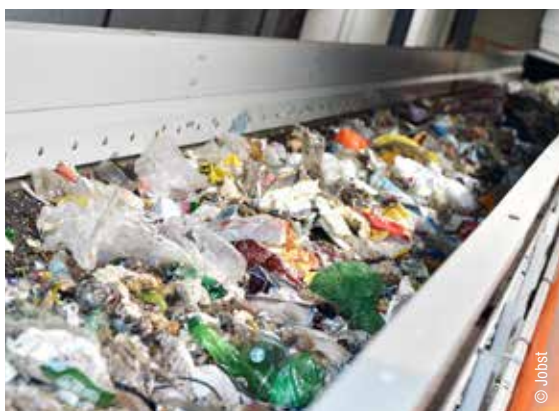
Förderband im Abfalllogistikzentrum
