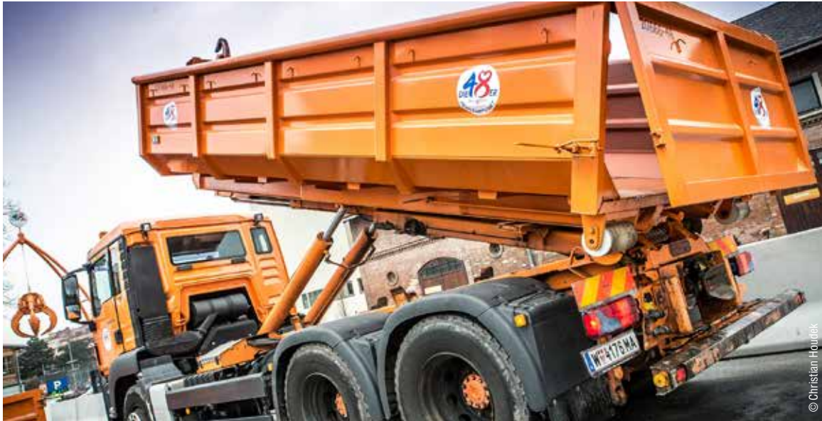
Mulde mit heckseitiger Pendelklappe auf Fahrzeug
