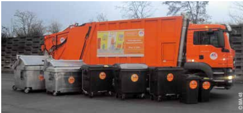
Müllsammelfahrzeug mit verschiedenen Behältertypen
