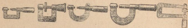
Fig. 2843. Fig. 2844. Fig. 2845. Fig. 2846. Fig. 2847. Mikrometerschraubenlehre , Fig. 2843, mit 1 mm. steigender Stahlschraube für directe Angabe von \frac{1}{20} mm.
