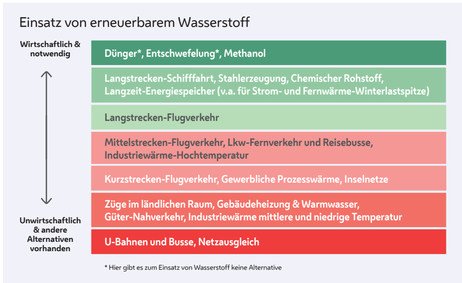
Abbildung 21 Priorisierung für den Einsatz von erneuerbarem Wasserstoff in einer klimaneutralen Welt; saisonal gespeichertes Gas für die Strom- und Fernwärme-Spitzenlastabdeckung mit besonderer Relevanz für Wien; eigene Darstellung nach The Economist auf Basis von Michael Liebreich [33]
