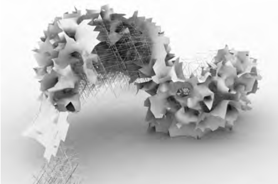
Digitale Modellstudie. (Mitte) Detail des digitalen Modells - verdichtete Stabstruktur mit synchronisierten Flächenfragmenten. (linke Seite) Physisches Konzeptmodell - Materialstudie aus selbsthaftenden Glasfasern. (oben)
