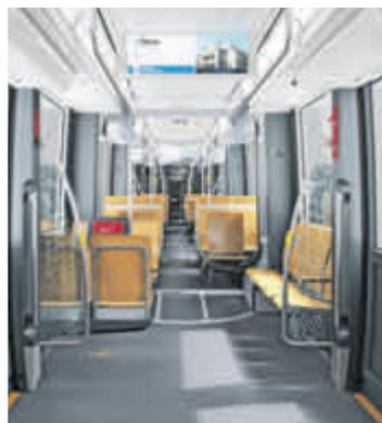
können 160 Fahrgäste befördert werden. Es gibt WLAN sowie Steckdosen an Bord. Alle Fahrzeuge sind mit energiesparender LED-Beleuchtung und einem modernen Fahrgastinformationssystem ausgestattet. Ein weiteres Plus: Neue Fahrzeugtechnik spart Energie. Doppelverglaste Fenster schützen vor Hitze und speichern im Winter die Wärme. **Telefon 01/904 44, wlb.at**
