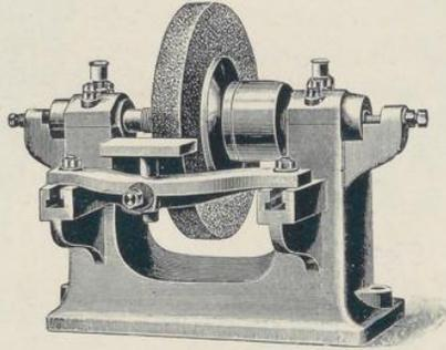
Die verhältnismäßig sehr kräftige Maschine dient für allgemeine Schleifzwecke in Gießereien, Maschinenfabriken und Eisenkonstruktions-Werkstätten und wird entweder auf einer starken Werkbank oder einem gemauerten Block befestigt. Die stählerne **Spindel** ist sicher gelagert und nachstellbar. In axialer Richtung dienen Spurschrauben zur sicheren Führung. Die **Handauflage** ist verstellbar.
