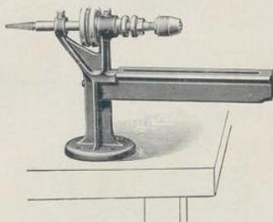
No. 4 hat Gewindezapfen für Polierscheiben usw. auf dem einen, Flanschen zum Einspannen von Sägen, Schmirgelscheiben usw. und Bohrfutter auf dem anderen Ende der **Spindel**.
