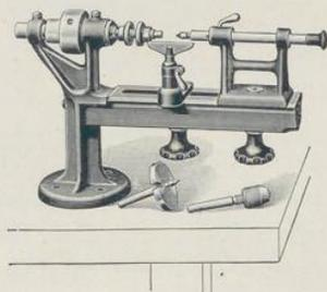
No. 5 hat **Reitstock** mit von Hand verschiebbarer Pinole, sowie **Handvorlage**. Die durchbohrte **Stahlspindel** hat 3 Einsätze: Mitnehmerscheibe, Bohrfutter und Säge- bzw. Schmirgelscheibendorn. Der Antrieb erfolgt durch 2-läufige Stufenscheibe.
