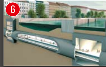
6 U2-STATION SCHOTTENRING Die erste U-Bahn-Station Wiens unter Wasser
