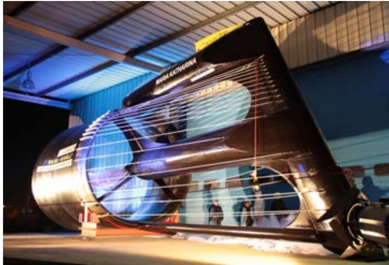
Strom Boje mit 250 cm Rotor und 70 kW Nennleistung © Aqua Libre Energieentwicklungs GmbH
