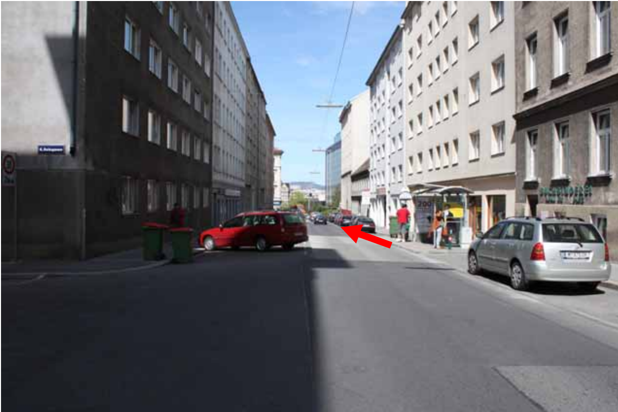
Abbildung 27: Haltestelle Rainergasse in Fahrtrichtung Alser Straße. Für die Benützung mit Niederflrigelenkbus ist eine Kapverlängerung um 3m notwendig.
