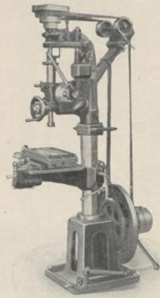
Für Kraftbetrieb Für Langlöcher automatisch bis 25 × 100 mm
