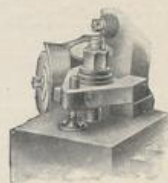
Befestigung auf der Drehbank mit Stahlhalter.
