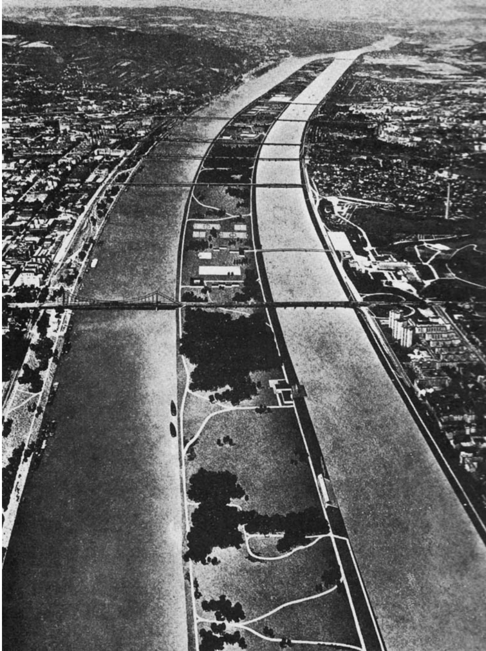
Abb. 34: Erstes Modell der Donauinsel, schrurgerade zwischen Strom und geplantem Entlastungsgerinne. Quelle: 150 Jahre Wiener Stadtbauamt, Seite 161
