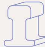
Ein Meter Gleis wiegt **50 bis 60 Kilogramm**.
