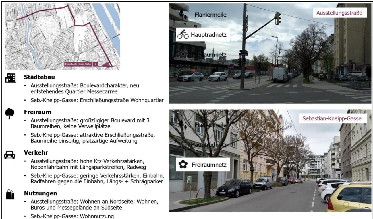
Die Ausstellungsstraße besitzt Boulevardcharakter und weist hohe Kfz-Verkehrsstärken auf. In der westseitigen Nebenfahrbahn finden sich zwei Längsparkreihen. Die Hauptfahrbahn weist einen 2+1 Querschnitt auf, mit einem Fahrstreifen Richtung Praterstern und zwei Fahrstreifen Richtung Elderschplatz. Beidseits davon bestehen jeweils Einrichtungsradwege.
