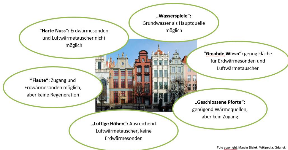
Abbildung 1: Übersicht der 6 Typen an Gebäuden mit unterschiedlicher Ausgangslage für die Nutzung von Umgebungswärme bei beengten Verhältnissen. (Quelle: Marcin Bialek, Wikipedia, Gdansk, eigene Darstellung)
