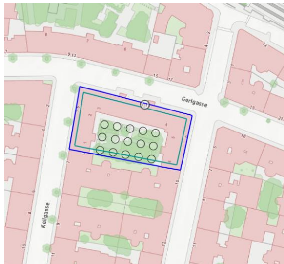
Abbildung 46: Position des Sondenfeldes im Innenhof der Liegenschaft (eigene Darstellung).
