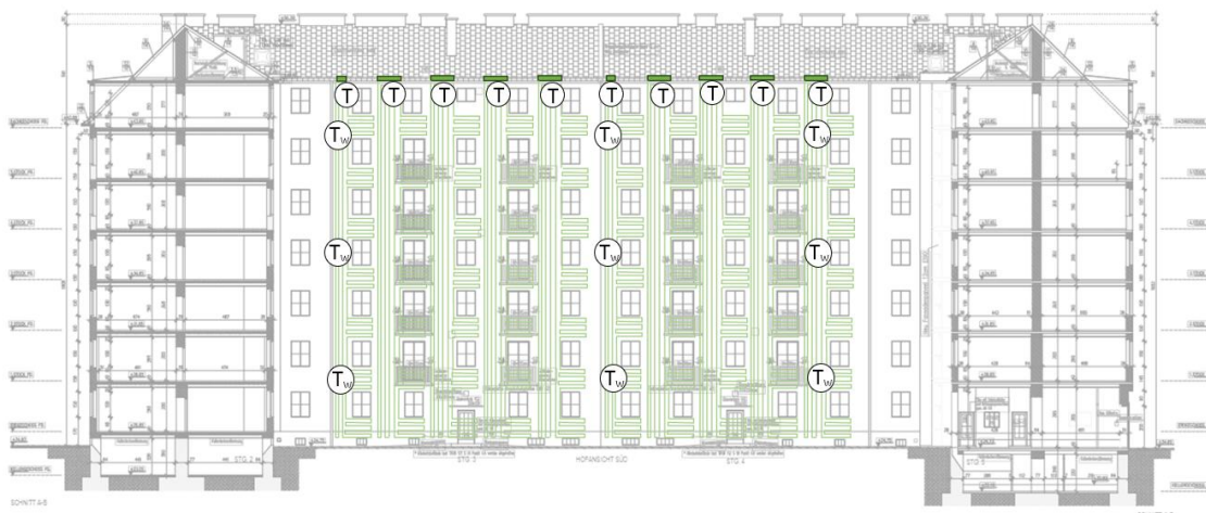
Abbildung 82: Verortung der Messfühler zur Überwachung der Fassadenaktivierung im Objekt Gerlgasse (eigene Darstellung).
