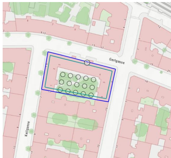
Abbildung 46: Position des Sondenfeldes im Innenhof der Liegenschaft (eigene Darstellung).
